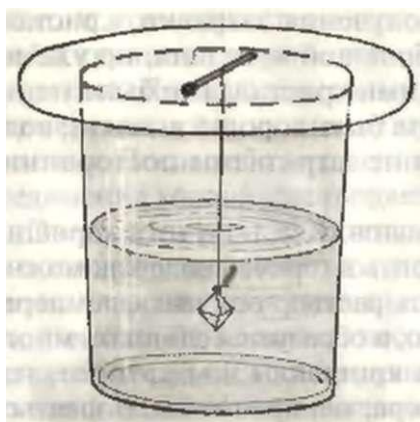
Рис. 19. Так растет подвешенный на нитке кристалл из насыщенного раствора при медленном испарении воды.
