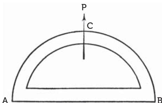
Рис. 14. Сила  $P$  должна увлекать аппарат вверх.
