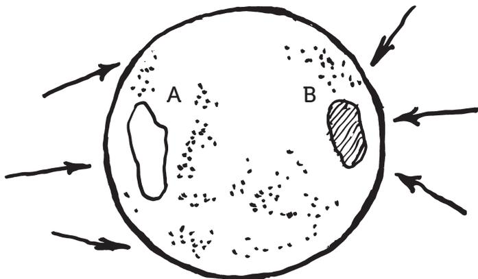
Рис. 16. Пустоты (А) и уплотнения (В) в толще земного шара отклоняют отвес.
