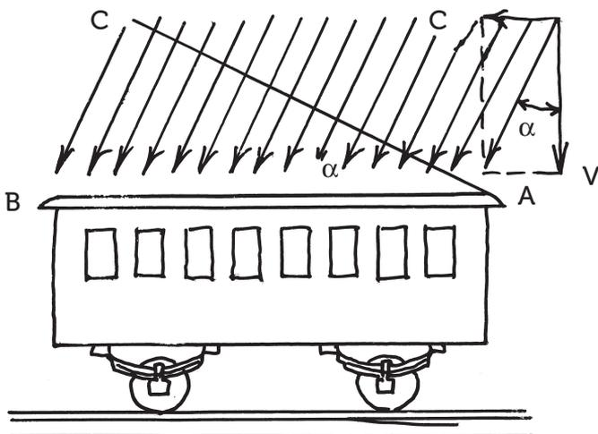
Рис. 86. Дождь, падающий на крышу движущегося вагона.
