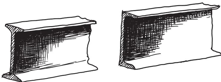
Рис. 56. Двутавровая (слева) и коробчатая балки.
