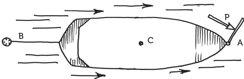
Рис. 83. При движении, более медленном чем течение, руль нужно прикрепить на носу.
