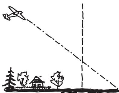
Рис. 46. Летчик летит по кривой большого радиуса (520 м) со скоростью 190 км/час.
