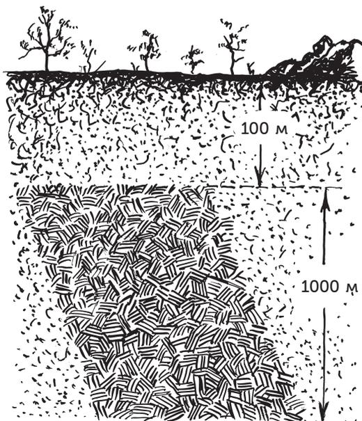
Рис. 19. Причина Курской аномалии: шток железной руды мощностью около тысячи метров на глубине ста метров.
