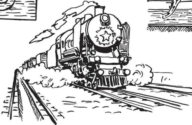
Рис. 4. Как паровозы на полном ходу набирают воду. Между рельсами устроен длинный водоем, в который погружается из тендера труба. Вверху налево — трубка Пито. При погружении ее в текущую воду уровень в трубе поднимается выше, чем в водоеме. Вверху направо — применение трубки Пито для набора воды в тендер движущегося поезда.
