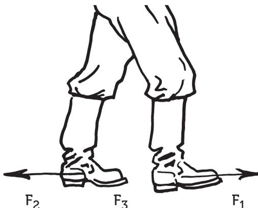
Рис. 9. Сила трения  $F_3$  делает возможной ходьбу.
