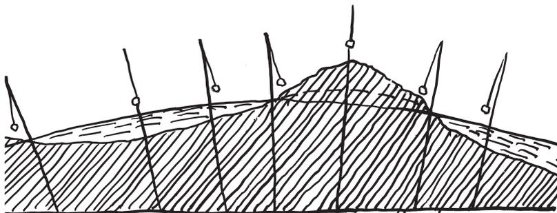
Рис. 17. Схема профиля земной поверхности и направления отвесов.
