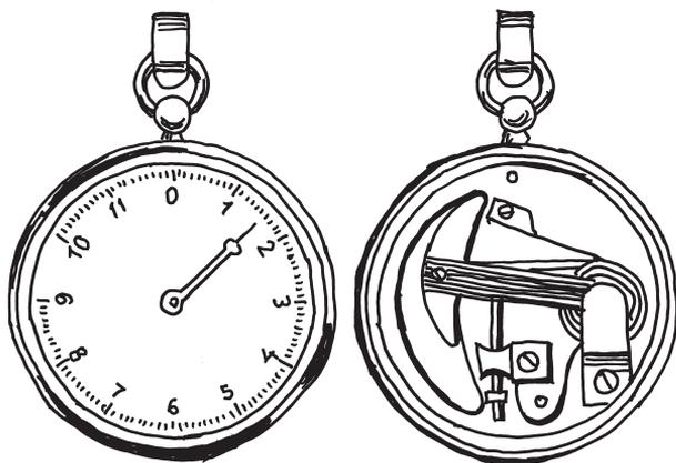
Рис. 72. Шагомер и его механизм.
