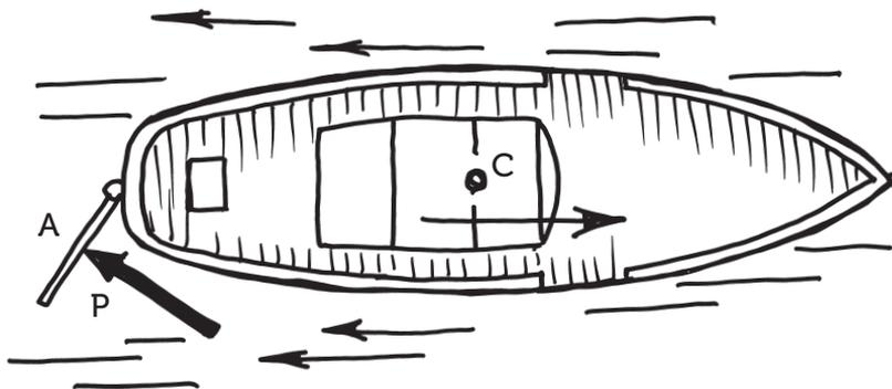
Рис. 82. При движении корабля под действием двигателя руль прикрепляется на корме.
