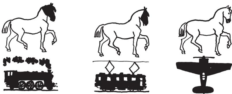
Рис. 62. Зачерненная часть контура лошади наглядно показывает, на какую долю веса приходится одна лошадиная сила в разных механических двигателях.
