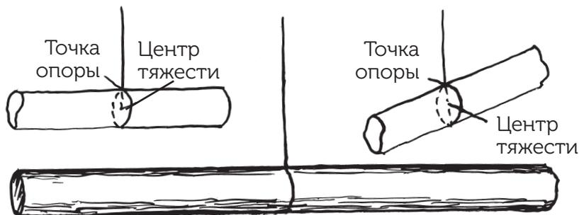
Рис. 29. Почему палка, подвешенная за середину, занимает горизонтальное положение?
