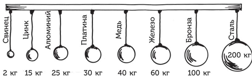
Рис. 52. Какими грузами рвутся проволоки из разных металлов? (сечение равно  $1 \text{ мм}^2$ ).
