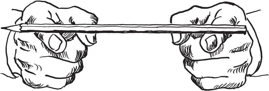
Рис. 10. При сближении пальцев карандаш двигается попеременно то в одну, то в другую сторону.
