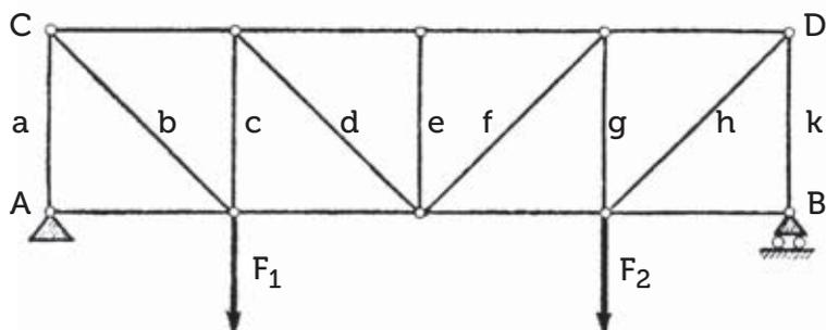
Рис. 57. Ферма заменяет в смысле прочности массивную балку.
