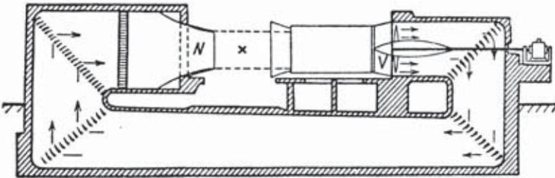
Рис. 3. Продольный разрез через аэродинамическую трубу. Модель крыла или самолета подвешивается в рабочем пространстве, отмеченном крестиком (x).
