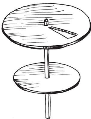
Рис. 81. Прибор для измерения скорости дождя.
