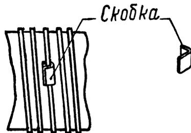
Рис. 93. Соединение концов перегоревшей спирали нагревательного элемента алюминиевой скобкой.
