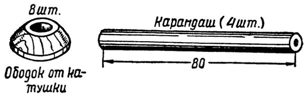
Рис. 125. Крепежные детали для телефонной трубки.
