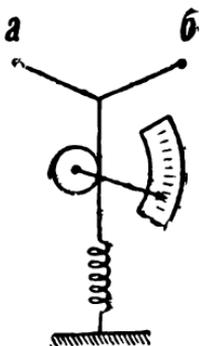
84. Электрические измерительные тепловые приборы часто делаются, как показано на схеме. По натянутой тонкой проволоке а—б пропускается измерительный ток. Проволока нагревается и удлиняется и под влиянием пружинки прогибается. Нитка к пружинке переброшена через цилиндрок, скрепленный с указателем прибора. Найти связь между отклонением стрелки и силой тока. Оценить условие наибольшей чувствительности такого прибора для данной силы тока.
