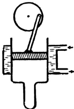
60. До широкого внедрения электричества для небольших мощностей употреблялся простой тепловой воздушный двигатель, состоящий из охлаждаемого водой цилиндра, непрерывно нагреваемого при датка-пальца и поршня, приводящего в действие маховик. Опишите, как и при каких условиях работают такого рода тепловые двигатели.
